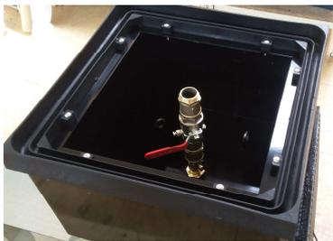
Une liaison d'alimentation de 2 mètres est raccordée sur la prise d'électricité ou d'eau permettant la raccordement au réseau. Le caisson est entièrement étanche ainsi que le tampon. La fixation de l'armoire se fait à l'aide de deux élingues métalliques. Un bouchon placé au fond du caisson permet la vidange.
